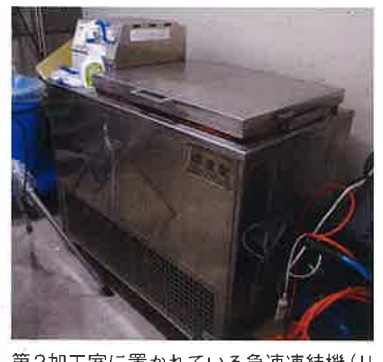
第2加工室に置かれている急速凍結機(リキッドフリーザ)。
